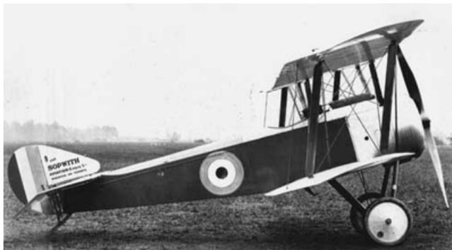
Elegante, fiable y muy popular, el Sopwith Pup fue un avión biplano monoplaza, de una sola bahía, alas escalonadas de igual envergadura y tren de aterrizaje fijo de configuración en forma de V. Estaba propulsado por el motor rotativo Le Rhône 9C de 80 hp, y dotado de una sola ametralladora Vickers de calibre 7,70 mm montada con el sincronizador Sopwith - Kaupe. Presentaba
