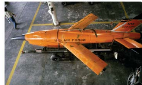
Uno de los BQM-34A empleados en la década de los 70 como UCAV por la USAF.
