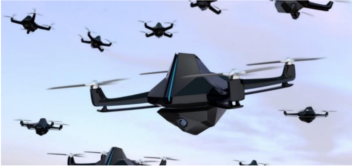
Figura 5.2. Separaciones entre RPAs de 5-15 veces su dimensión media impide las colisiones.
