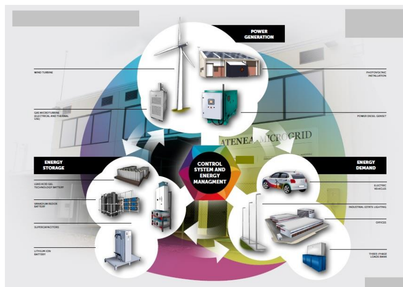
Figura 2. Ejemplo de Microrred Industrial: Sistema de Gestión y Control de la Energía. Fuente: propia
