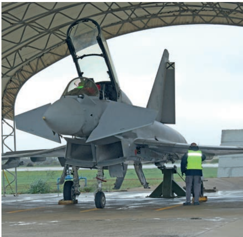
Prueba de punto fijo de un C.16. (Imagen: comandante Alfredo Jimenez del Ala 11)
